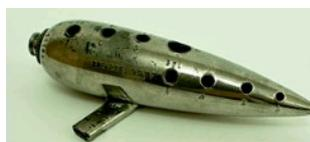
Form und Position der Löcher ist nicht entscheidend für die result. "Resonanzfrequenz", sondern die Anzahl und Größe der Löcher und somit „Masse“ die auf die Feder (Innenvolumen) wirkt.
